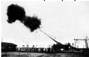
Le canon qui bombarde Paris (1918) : longueur 36 m, poids 750 t, calibre 210 mm, obus 104 à 106 kg, vitesse d'éjection 1600 m/s, porté 126 km !
